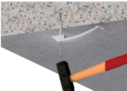
Inslaan in plafond
