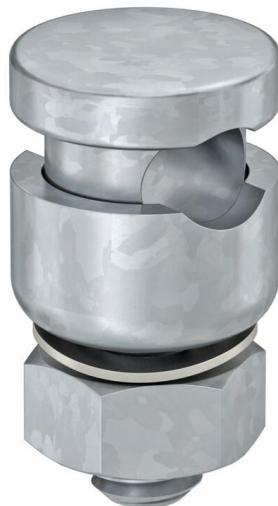
Anschlussklemme für Rundleiter ø 8 bis 10 mm Klemmschraube, Mutter und Federscheibe inkl. vormontierter Druckwanne aus feuerverzinktem Stahl.
