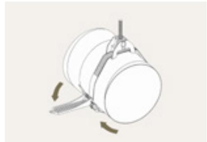
UNO Spanner zum sicheren Spannen des Bandes
