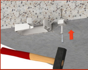
Fixation facile de la cheville grâce au satellite.
