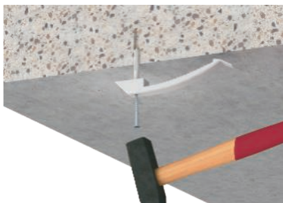
Einschlagen in die Decke
